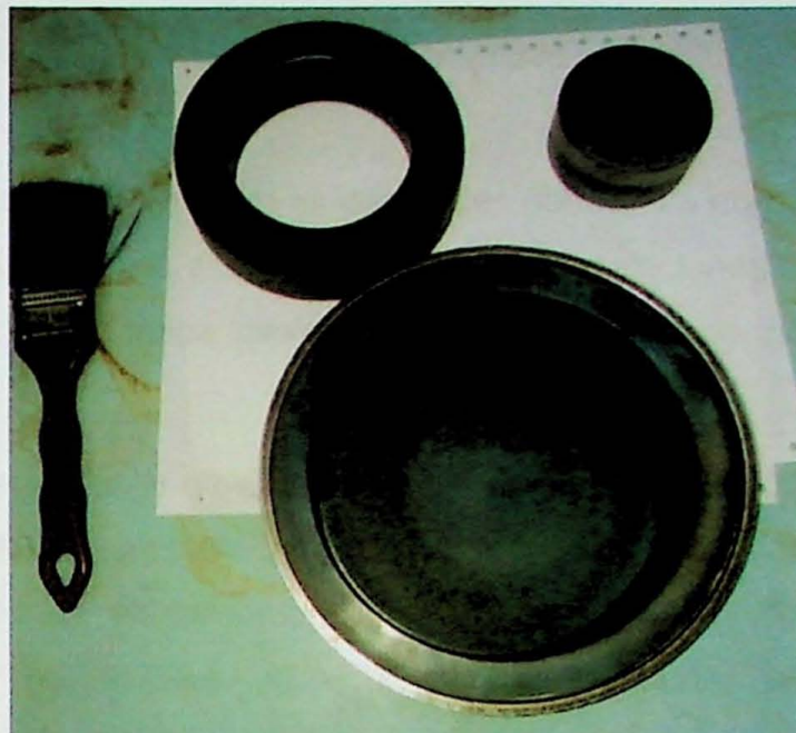
FOTO 6 – Panela revestida de ágata, e seus anéis, acessório do moinho.
