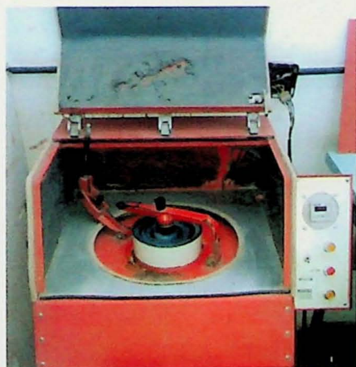
FOTO 5 – Moinho de anéis e a posição de funcionamento da panela.
