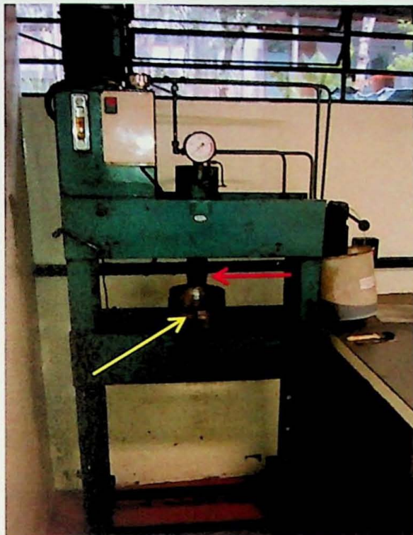
FOTO 4 – Visão da Prensa Hidráulica das dependências do LTA. A seta amarela indica a posição onde a amostras é colocada e em seguida é prensada pelo pistão até que se obtenha a fração desejada.
